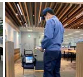
定期的な室内空気環境調査
